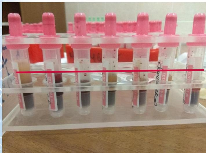
Для предотвращения ошибок в измерениях или значениях показателей требуется обеспечивать точный объем крови при взятии.
